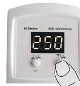
После последнего нажатия одной из кнопок микроконтроллер отсчитывает 5 секунд и если нет команд запоминает выставленные значения и переводит устройство в обычный режим.
