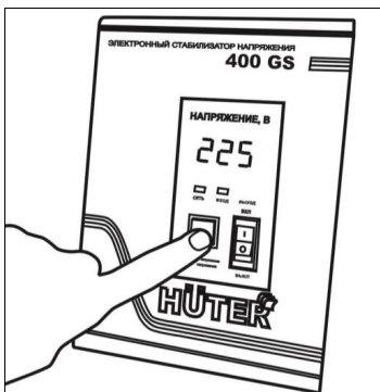
Рис. 5 Проверка входного напряжения
