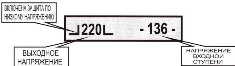
В режиме стабилизации защиту по нижнему напряжению можно отключать, при этом остальные защиты остаются включенными
