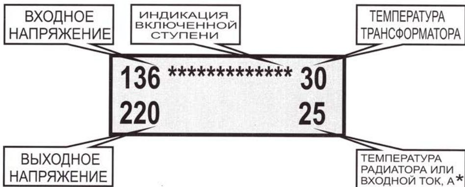
**\*** в зависимости от типа стабилизатора
