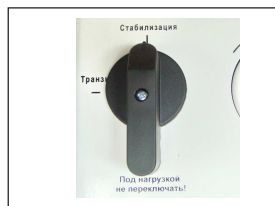
Рис. 5. Переключатель режима работы
