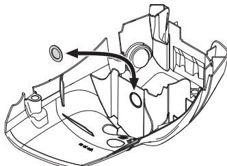
Для работы при низкой температуре или в условиях снегопада предусмотрена специальная крышка, укрепленная на блоке стартера. Она уменьшает доступ холодного воздуха и предохраняет от попадания большого количества снега.
