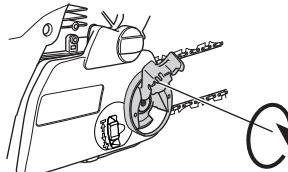
При установки новой цепи следует часто проверять ее натяжение , пока цепь не приработается. Регулярно проверяйте натяжение цепи. Регулярно проверяйте натяжение цепи. Правильно натянутая цепь обеспечивает высокое качество пиления и дольше служит.
