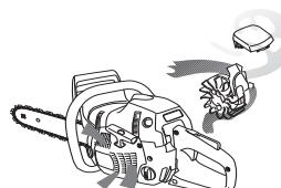
**ВАЖНО!** Для осуществления метода центробежной очистки нужно постоянно выполнять техническое обслуживание и уход за системой. Необходимо чистить воздухозаборник стартера, лопасти вентилятора на маховике, пространство вокруг маховика, входного коллектора и карбюратора.
