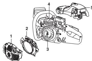
Производите очистку системы охлаждения щёткой раз в неделю или чаще, если этого требуют условия работы. Загрязненная или засоренная система охлаждения может привести к перегреву машины и вызвать повреждение поршня и цилиндра.
