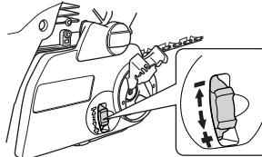
Цепь считается натянутой правильно, если она свободно проворачивается рукой. После этого, удерживая носок пильного полотна в верхнем положений, затяните гайки крепления пильного полотна универсальным ключом.
