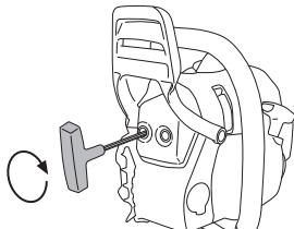
В некоторых глушителях предусмотрен специальный искрогаситель. Если ваша машина оборудована таким глушителем, сетку фильтра следует чистить раз в неделю. Наилучшие пользоваться стальной щеткой. Забитая решетка приводит к работе с горячим двигателем, что дает серьезные повреждения двигателя.
