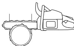
Существуют методы валки деревьев с полотном, меньшим диаметром ствола. Однако эти методы достаточно опасны, т.к. область отдачи полотна входит в контакт с предметом.
