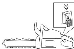
**ПОМНИТЕ!** Выключатель Запуск/Остановка автоматически переходит рабочее положение. В целях избежания непроизвольного запуска, головка свечи должна быть всегда снята со свечи когда вы оставляете машину без присмотра.
