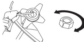
Нейлоновая прокладка конгрейки не должна быть изношена настолько, чтобы ее можно было поворачивать вручную. Прокладка должна выдерживать усилие минимум 1,5 Нм. Гайку следует заменить после ее использования приблизительно 10 раз.
