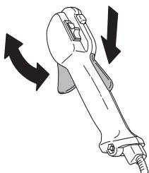
См. указания в разделе Запуск. Включите машину и полностью откройте дроссель. Отпустите рычаг дросселя и удостоверьтесь, что режущее оборудование останавливается и остается неподвижным. Если после постановки дросселя в положение холостого хода режущие устройства продолжают вращаться, следует проверить регулировку холостого хода
