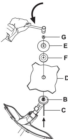
Установка щитка и триммерной головки
