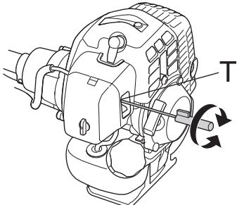
**ПРЕДУПРЕЖДЕНИЕ!** Если холостые обороты невозможno отрегулировать так, чтобы режущее оборудование стояло неподвижно, обращайтесь к продавцу/в мастерскую. Не пользуйтесь машиной, пока не будет выполнена точная регулировка или ремонт.
