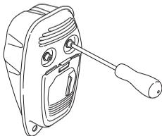
Если глушитель на вашей машине дополнительно оборудован искрогасящим фильтром, его следует регулярно прочищать. Забившийся фильтр может вызвать перегрев
