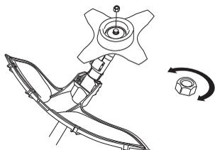
Нейлоновая прокладка контргайки не должна быть изношена настолько, чтобы ее можно было поворачивать вручную. Прокладка должна выдерживать усилие минимально 1,5 Нм. Гайку следует заменить после ее использования приблизительно 10 раз.
