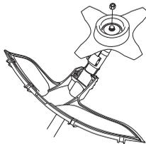
При сборке надо затягивать гайку против направления вращения режущего оборудования. При разборке надо отвинчивать гайку в направлении вращения режущего оборудования. (ЗАМЕЧАНИЕ! Гайка имеет левостороннюю
