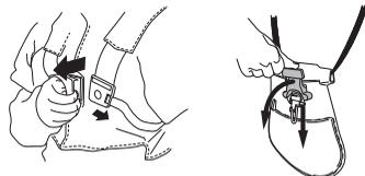
Удостоверьтесь, что привязные ремни оснастки были правильно расположены. Когда машина будет отрегулирована, проверьте работу системы быстрого отстегивания оснастки.
