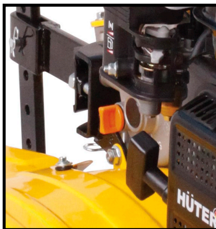
Горловина для заливки масла в редуктор
