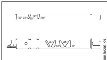
Пользоваться опилочным шаблоном STIHL (специальные принадлежности, см. таблицу "Инструменты для заточки") – универсальный инструмент для контроля угла заточки и переднего угла, высоты ограничителя глубины, длины зуба, глубины паза и для очистки пазов и впускных масляных отверстий.
