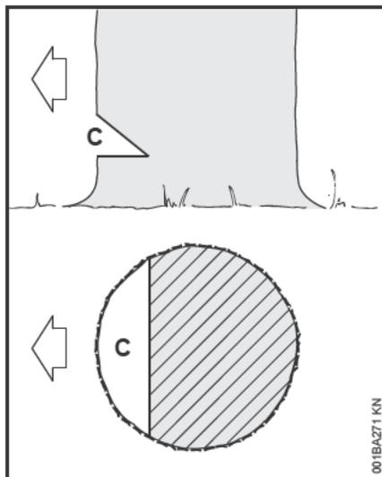
Подпил (С) определяет направление валки дерева.
