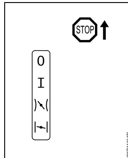
**STOP-0** – двигатель остановлен – зажигание выключено
