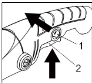
Вы можете активизировать режим постоянства вращения, нажав на кнопку (1) и кнопку фиксации (2) одновременно. Чтобы отключить данный режим нажмите кнопку фиксации выключателя (1).
