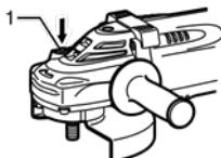
Никогда не задействуйте замок вала при вращающемся шпинделе. Это может привести к повреждению инструмента. Нажмите на замок вала для предотвращения вращения шпинделя при установке или снятии дополнительных принадлежностей.
