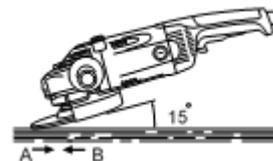
специальный защитный кожух, предназначенный для отрезных кругов.
