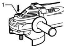
Никогда не задействуйте замок вала при вращающемся шпинделе. Это может привести к повреждению инструмента. Нажмите на замок вала для предотвращения вращения шпинделя при установке или снятии дополнительных принадлежностей.
