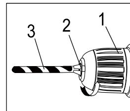
Рис. 8 Установка оснастки
