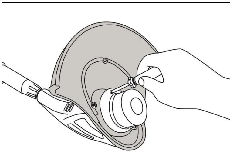
Рис. 4 Фиксация кожуха
