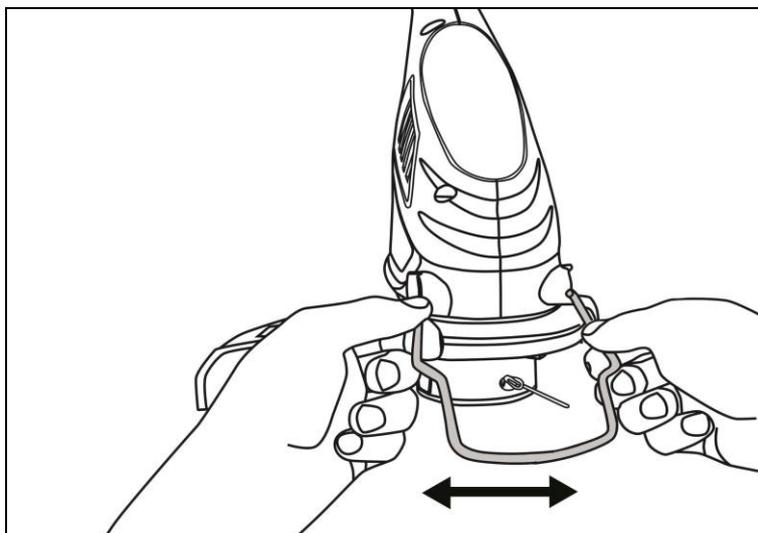
Рис. 5 Установка ограничителя
