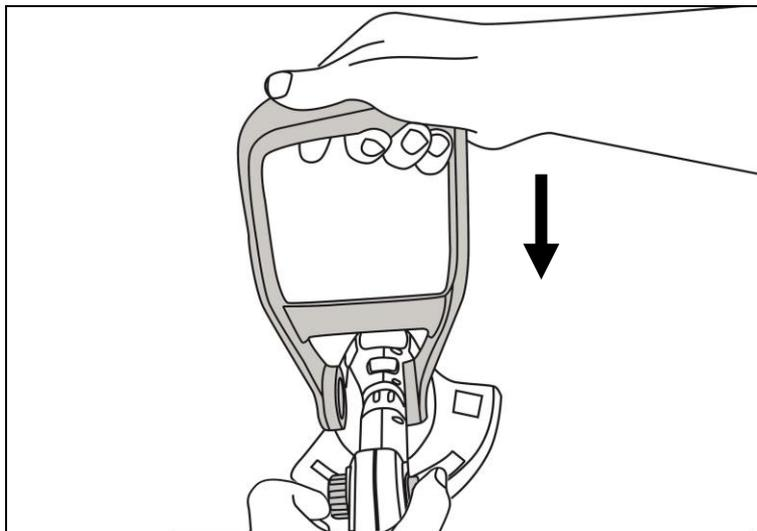
Рис. 5 Установка рукоятки
