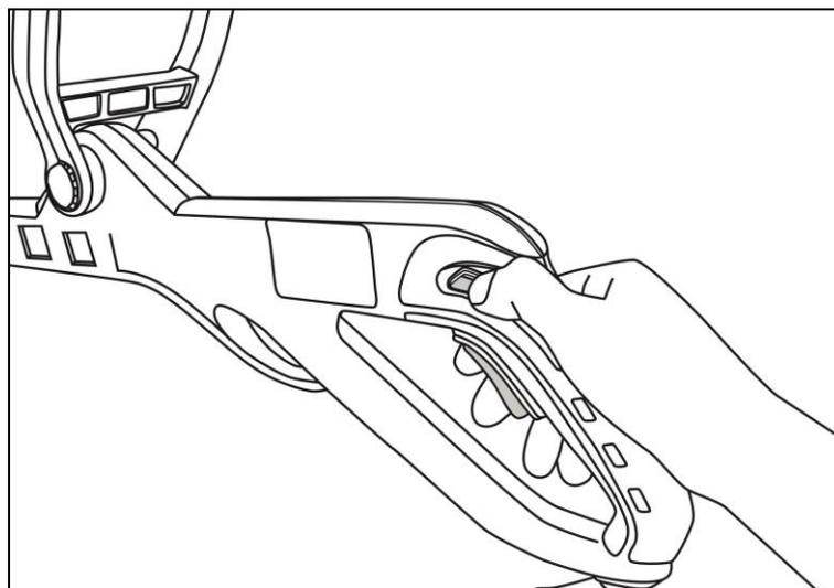
Рис. 13 Включение триммера
