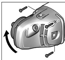
Редукторная головка может поворачиваться с интервалом в 90°. Таким образом выключатель может быть установлен в удобное для работы положение, например, для отрезных работ с вытяжным колпаком и направляющими салазками (21) или для левши.
