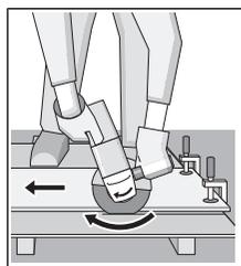
Всегда ведите электроинструмент против направления вращения. В противном случае существует опасность **неконтролируемого** вырывания инструмента из прорези. При резке профилей или четырехгранных труб начинайте рез на наименьшем поперечном
