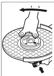
Должным образом затянутую, исправную быстрозажимную гайку можно открутить поворотом кольца с накаткой от руки против часовой стрелки. **Никогда не применяйте для откручивания заклинившей быстрозажимной гайки клещи, обязательно используйте рожковый ключ под два отверстия.** Накладывайте рожковый ключ под два
