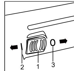
выключателя в положение “0” (Выкл), надавите на тыльную сторону выключателя (3). Выключатель переключится в положение “0” (Выкл).
