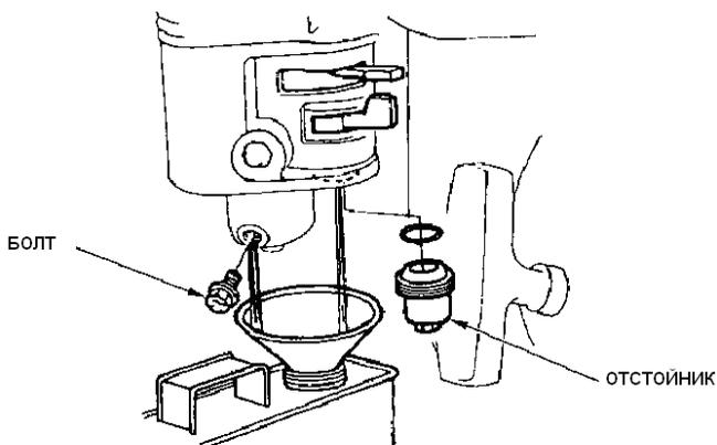
3. Слив топливо, верните на место сливную пробку и отстойник. Хорошо их закрепите.
