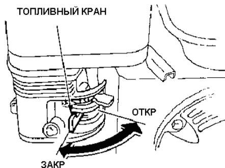
«Закрыто», чтобы предотвратить затопление карбюратора и утечку топлива.
