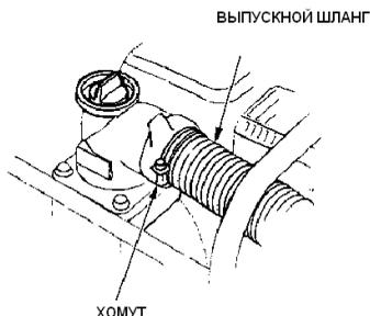
Лучше всего использовать короткий шланг большого диаметра, это позволит уменьшить трение жидкости и увеличить производительность насоса. Использование длинного шланга с небольшим диаметром увеличит трение жидкости и понизит мощность насоса.
