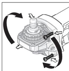
Корпус редуктора может поворачиваться с интервалом в 90°. Этим выключатель может быть поставлен в удобное для работы положение, например, для левши.
