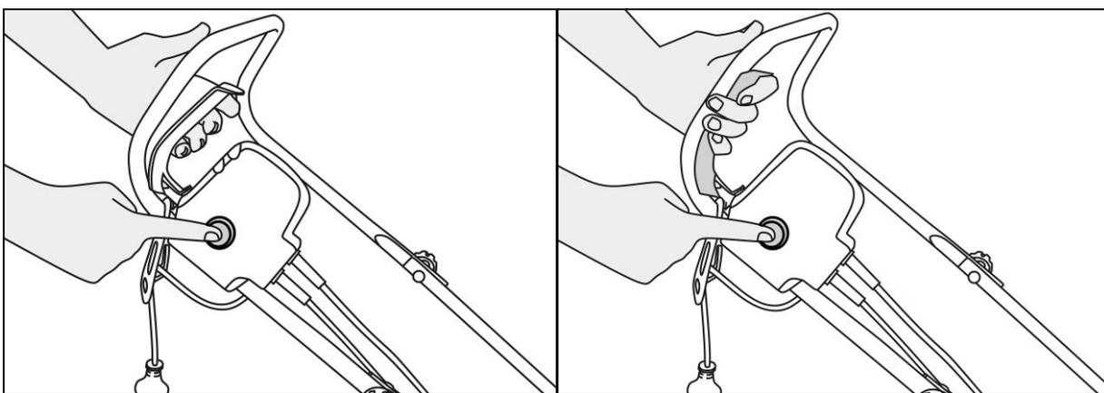
Рис. 8. Запуск для моделей с обычным рычагом
