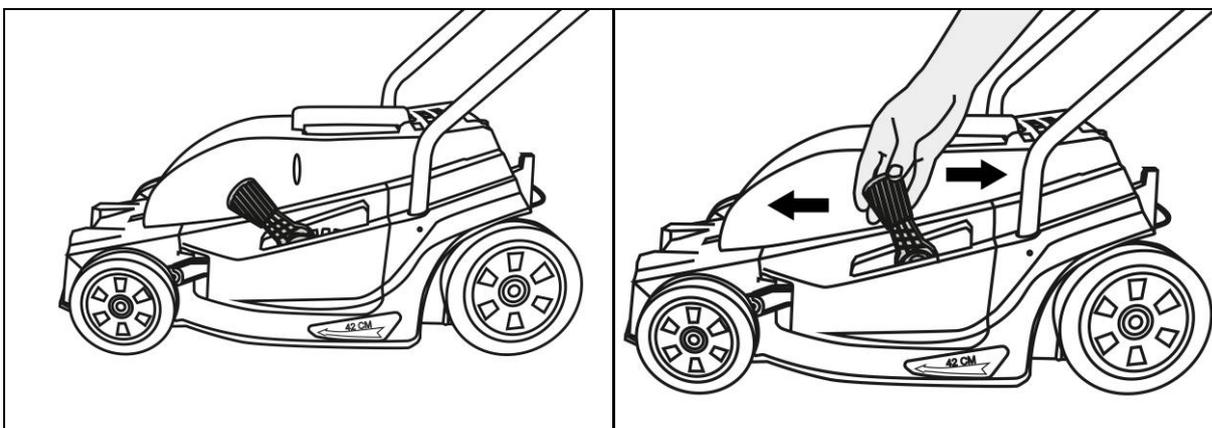
Рис.12. Регулировка высоты среза с помощью центрального рычага
