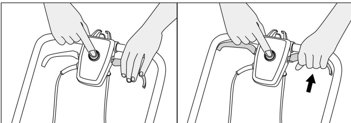
Рис. 9. Запуск для моделей с двойным рычагом
