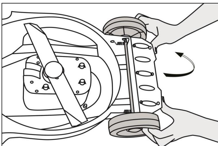
Рис. 10. Регулировка высоты среза передней и задней оси
