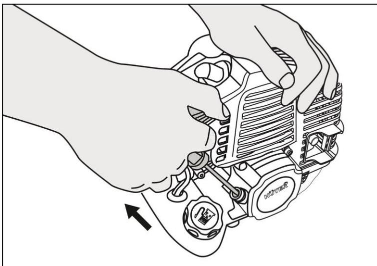
Рис. 23. Запуск двигателя
