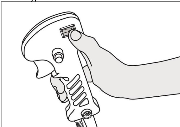
Рис. 26. Остановка двигателя
