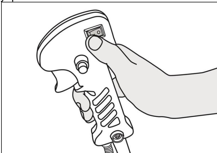
Рис. 21. Включение зажигания
