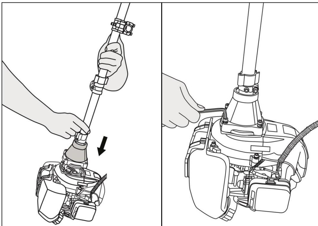
Рис. 6. Установка штанги
