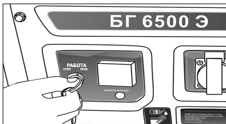
Рис. 17. Запуск двигателя электростартером
