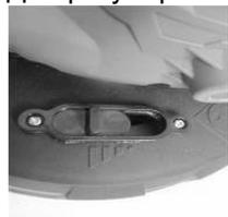
Для большего удобства работы в углах, Вы можете снять сегмент от шлифовальной платформы.
