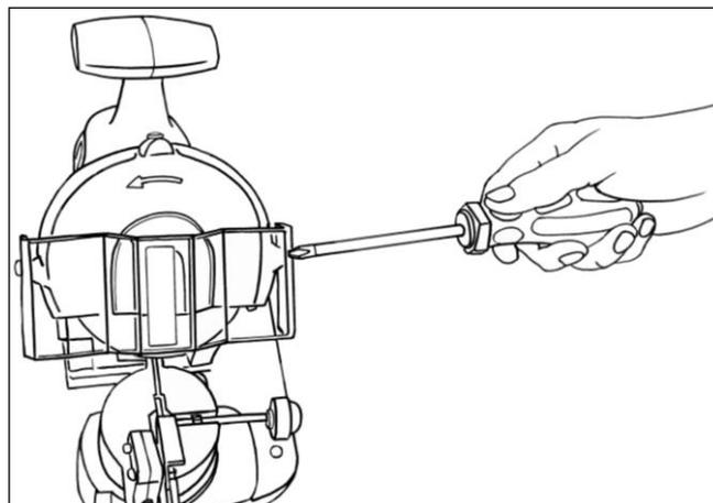
Рис.17 Снятие защиты
