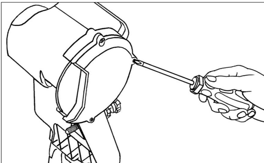
Рис.15 Снятие защиты
