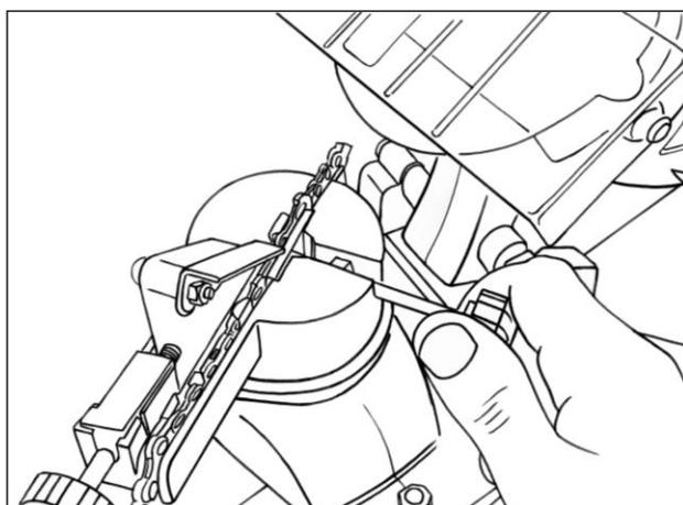
Рис.10 Фиксация цепи в станке Т-220
