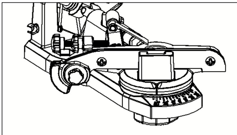
Рис.6 Установка рабочего стола на основание
