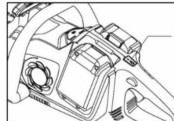
Для начала работы нажмите на клавишу защиты от случайного включения (1), а затем на клавишу включения (2).
