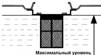
Рис. 10 Максимальный уровень топлива в топливном баке
