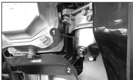
**Рис. 21 Слив топлива из карбюратора**
