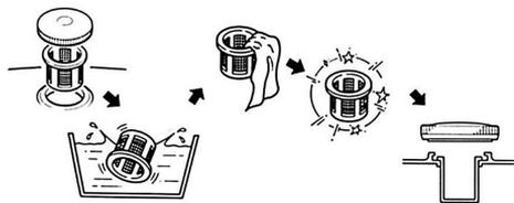
**Рис. 19 Обслуживание сетчатого фильтра в горловине топливного бака**
