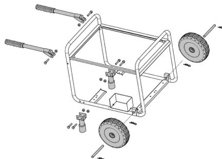
Рис. 4 Установка колёс, рукояток и опор рамы GG3200EW
