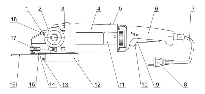
1 - редуктор; 2 - ручка; 3 - винты; 4 - электропривод; 5 - упор; 6 - ручка с выключателем; 7 - шнур питания; 8 - штепсельная вилка; 9 - клавиша выключателя; 10 - клавиша предохранителя; 11 - крышка; 12 - кожух; 13 - шпиндель; 14 - гайка; 15 - диск; 16 - круг; 17 - хомут; 18 - кнопка.
