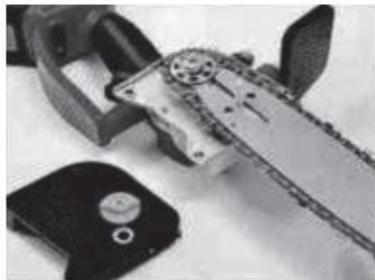
Снимите верхнюю крышку корпуса, наденьте цепь на шину, затем на звездочку и установите шину на направляющий элемент.
