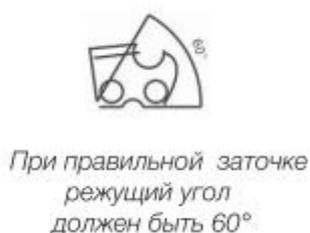
Затачивание делают «от себя», параллельно отметке — риске, которая есть на всех зубьях. Косая риска - это указатель угла заточки. Усилия и число движений должны быть равномерными на каждом зубце.
