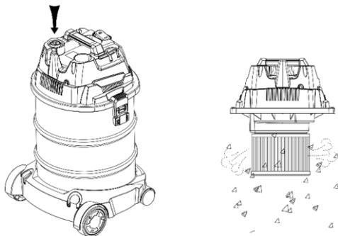
Образовавшийся воздушный поток сбросит пыль с фильтра вниз. Это позволит эффективно избежать засорения фильтра.
