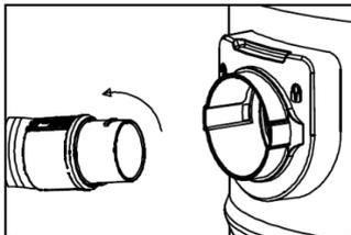
2. При использовании функции обдува вставьте шланг в отверстие для обдува и поверните его по часовой стрелке до фиксации.
