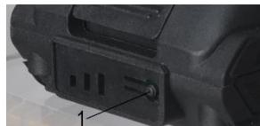
**ВНИМАНИЕ!** Чтобы сохранить работоспособность Li-Ion батареи, она не должна заряжаться при температуре ниже 0°C или выше 45°C. Если температура аккумуляторной батареи выше 45°C или ниже 0°C, процесс заряда батареи не произойдет. При этом индикатор (1) будет гореть зеленым после подключения зарядного устройства к батарее. Если аккумуляторная батарея повреждена, процесс заряда батареи не произойдет. При этом индикатор (1) будет гореть зеленым после подключения зарядного устройства к батарее.
