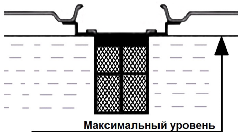
Рис. 10 Максимальный уровень топлива в топливном баке
