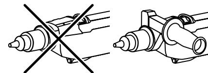
Работа без установленной дополнительной рукоятки **ЗАПРЕЩАЕТСЯ**
