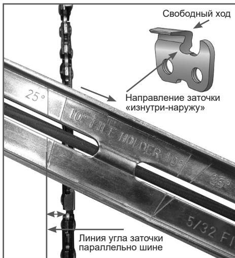
Рис. 22 Расположение линии угла заточки
