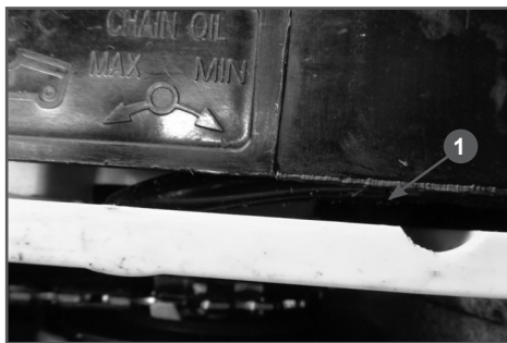
Рис. 8 Винт регулировки подачи масла
