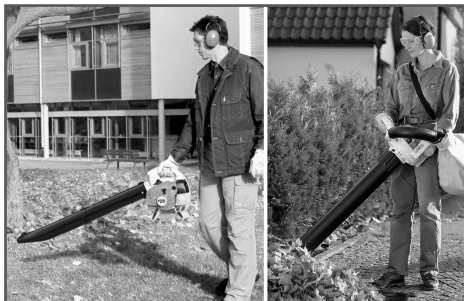
Рис. 9 Положение оператора при работе воздуходувным устройством
