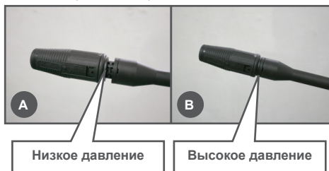
Рис. 12 Положения головки струйной трубки
