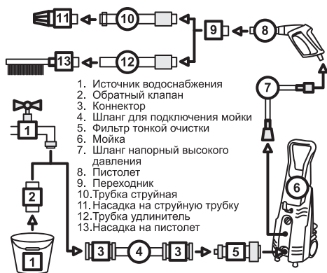
Рис. 13 Схема подключения аппарата с дополнительным оборудованием
