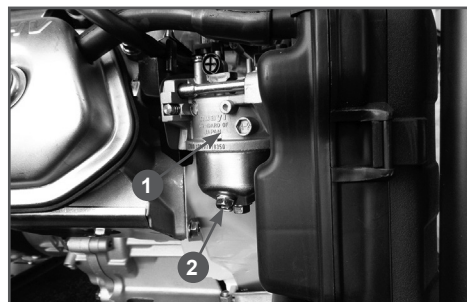
Рис. 18 Слив топлива из карбюратора 1. Карбюратор 2. Болт
