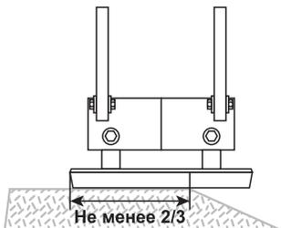
**Рис. 12** Расположение виброплиты на краю обрабатываемой поверхности
