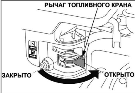
Рис. 8 Топливный кран открыт
