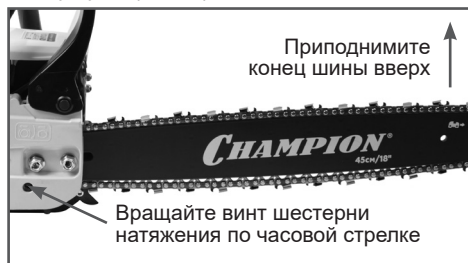
Рис. 5 Регулировка натяжения цепи
