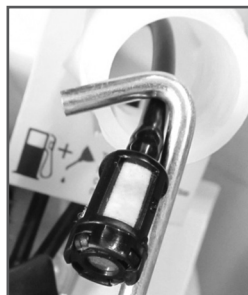
Рис. 12 Извлечение топливного фильтра
