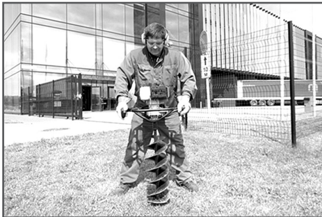
Рис. 8 Положение тела оператора при работе мотобуром
