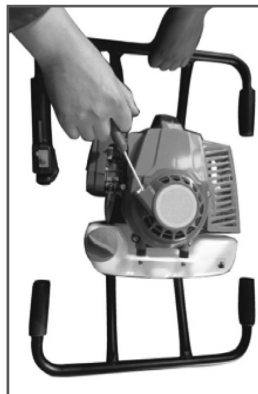
Рис. 9 Свободный ход шнура стартера
