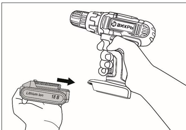
Рис. 6 Установка аккумулятора
