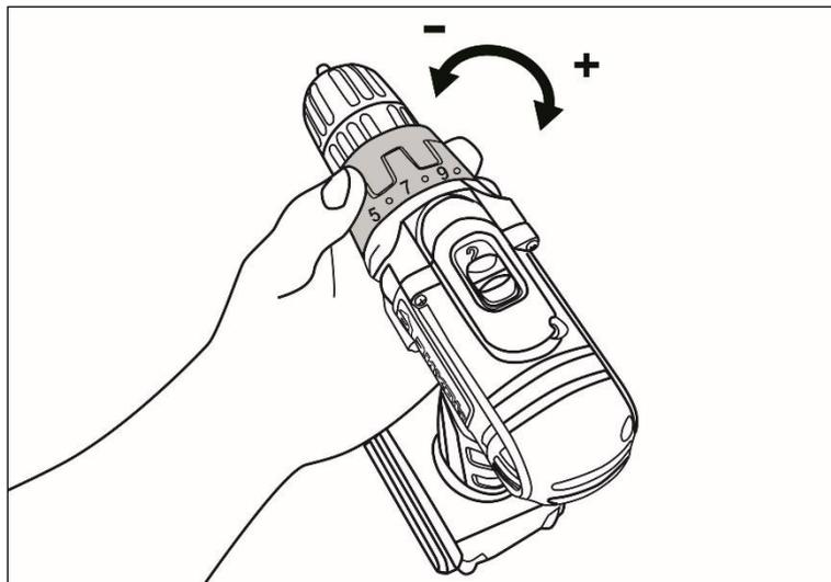
Рис. 10 Установка крутящего момента
