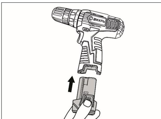
Рис. 7 Установка аккумулятора
