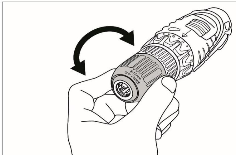
Рис. 8 Откручивание патрона
