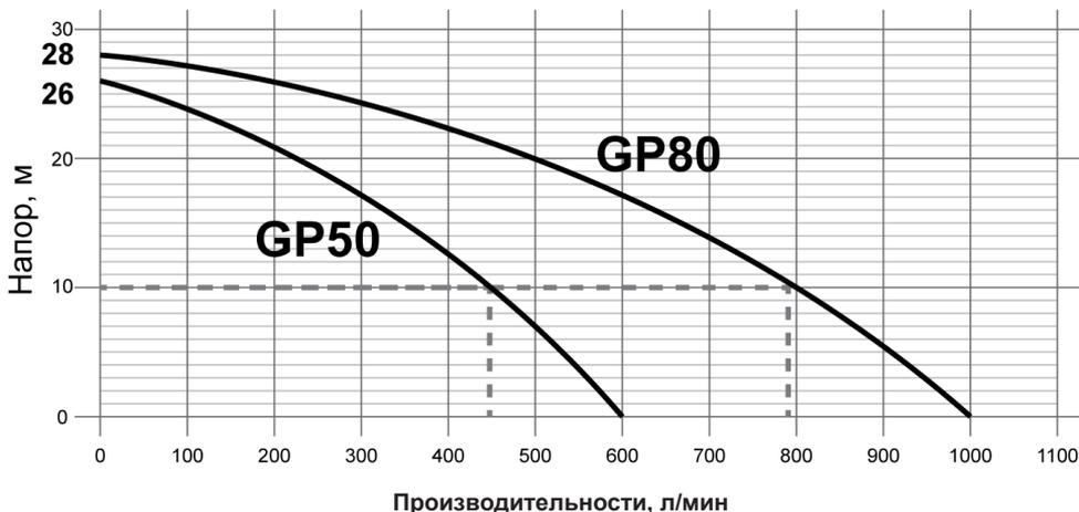
Рис. 24 График зависимости производительности мотопомпы от высоты подъема
