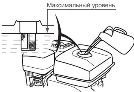
Рис. 8 Максимальный уровень топлива в топливном баке
