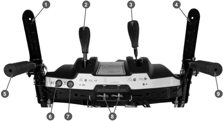
Рис. 2 Панель управления (вид со стороны оператора)
