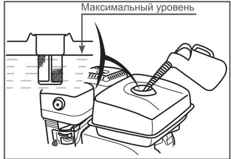
**Рис. 19 Максимальный уровень топлива в топливном баке**
