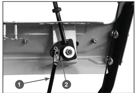
**Рис. 6 Подключение тяги к рычагу переключения передач**
