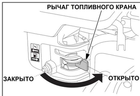
Рис. 22 Рычаг топливного крана
