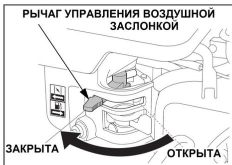
Рис. 21 Рычаг управления воздушной заслонкой
