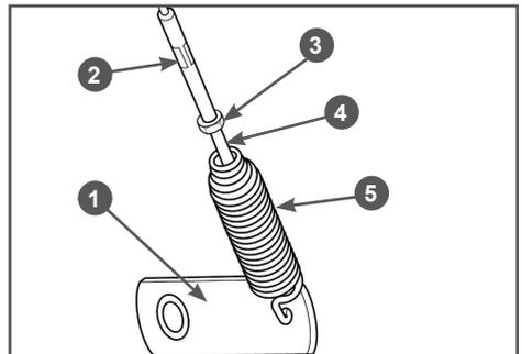
**Рис. 9 Регулировка длины тросов включения хода и шнека**
