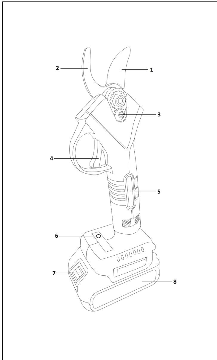
Рис. 1 Устройство секатора
