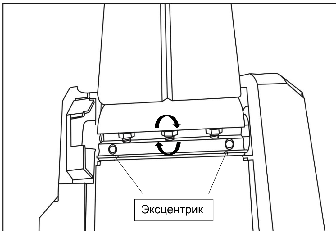
Рис.3 Замена режущего ножа.
