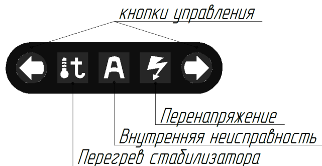
Рисунок 3. Кнопки управления и пиктограммы неисправностей.
