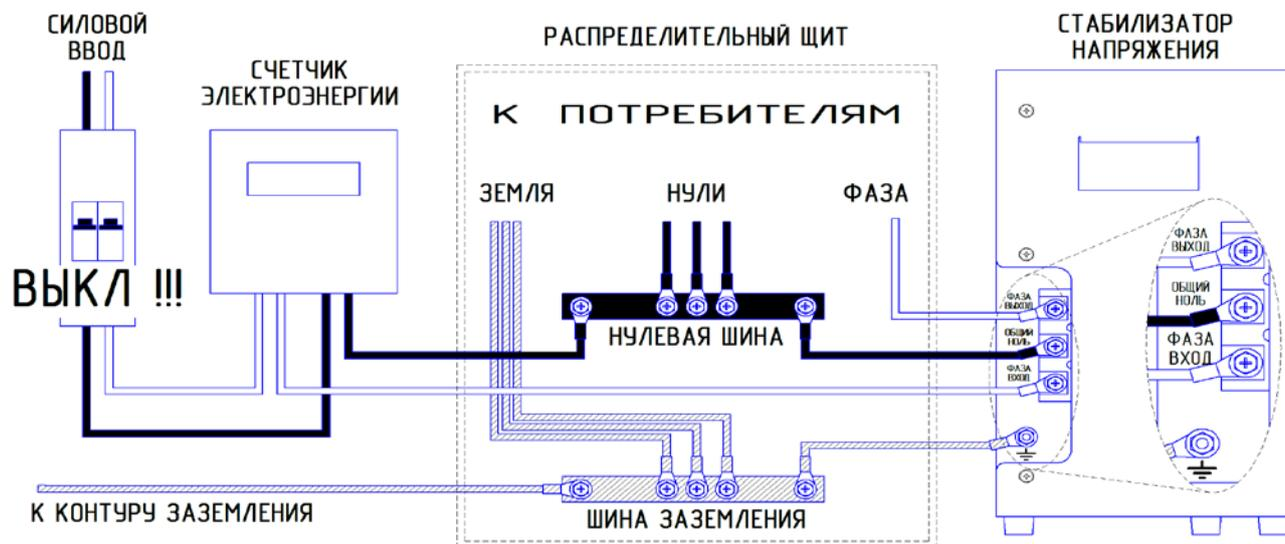
Рисунок 1. Рекомендуемая схема подключения стабилизатора к сети.
