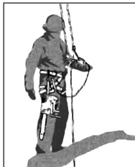
Рис. 19 Пример крепления пилы к ремню оператора
