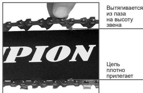
Рис. 5 Регулировка натяжения цепи
