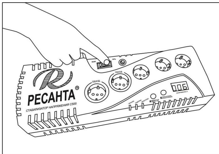
Рис. 3. Включение стабилизатора
