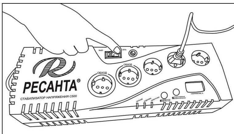
Рис. 7. Подключение нагрузки
