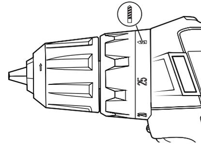
Во избежание травм, не заворачивайте шурупы в положении
