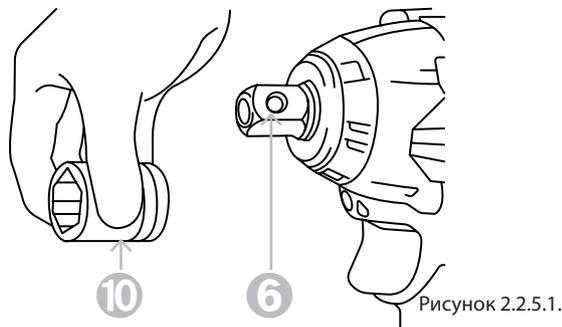
Совместите отверстие в боковой поверхности ударной головки «10» (рисунок 2.2.5.1.) со штифтом на квадратном хвостовике «6» и нажмите на головку, чтобы она зафиксировалась. При необходимости слегка постучите. Чтобы снять ударную головку, просто потяните ее.
